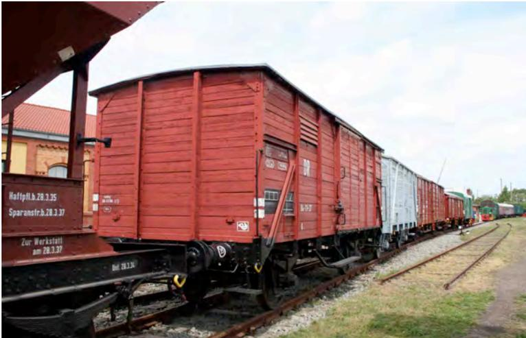
Bild 1: Alte Güterwaggons verursachen den größten Teil des Lärms auf Eisenbahnstrecken. Sie gehören aufs Abstellgleis oder in die Werkstatt, um mit neuen Flüsterbremsen ausgerüstet zu werden.
