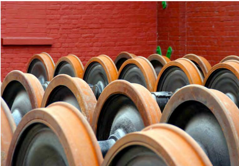
Bild 2: Leise Räder sind das Ziel der Aktion „Leise Bremsen“, denn durch die alten Graugussbremsen werden die Räder „aufgeraut“.
