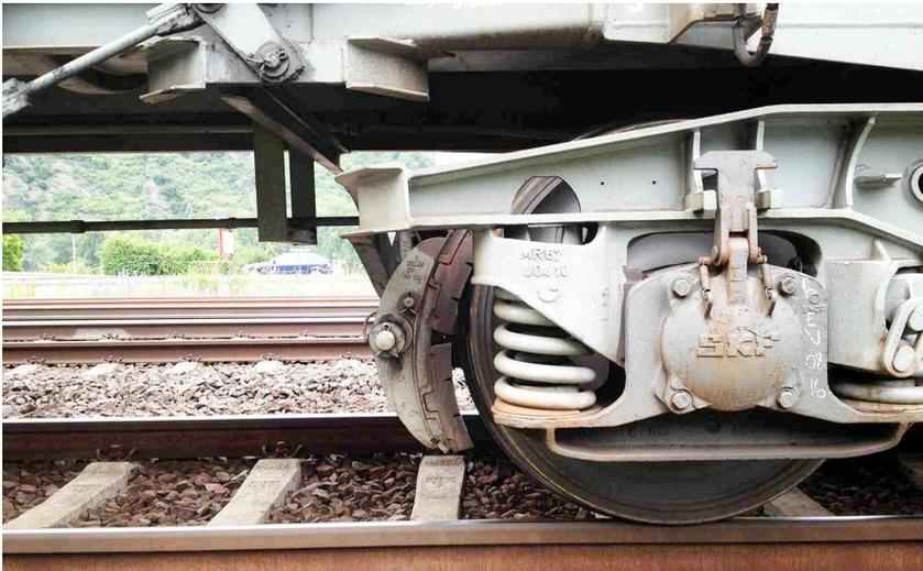
Bild 2: Der Kontakt zwischen Rad und Schiene macht 90 Prozent der Lärmemissionen aus. Kunststoffbremsen sorgen für glatte Räder, damit auch die Schienen glatt bleiben und die Züge flüsterleise vorbeifahren.
