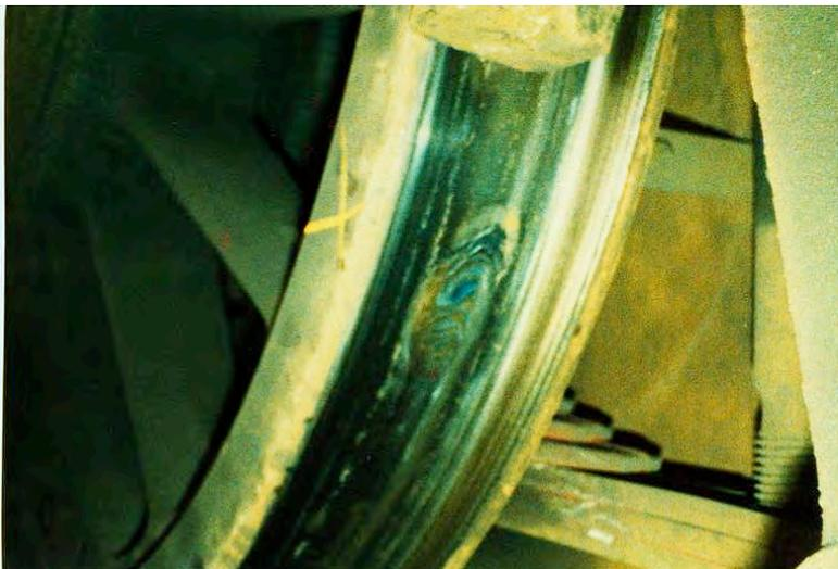
Bild 2: Alte und marode Güterwaggons mit Radlaufflächen, die Verriffelungen und Aufschweißungen zeigen, sind Hauptursache für Bahnlärm.
