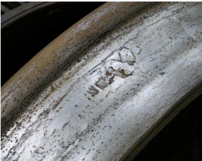
Bild 2: Zu den „lärmenden“ Raddefekten gehören auch Materialausbrüche.
