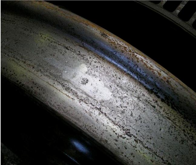
Bild 1: Flachstellen entstehen durch Blockieren der Räder und sind eine der Hauptursachen für die hohen Lärmwerte von Güterzügen.
