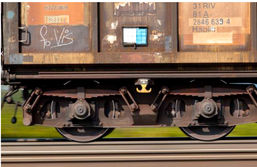
Bild 1: Ungefedert liegen die schweren eisernen Fahrgestelle auf den Schienen. Kleinste Unebenheiten an Rädern und Schienen resultieren in lauten Geräuschen – Bahnlärm!
