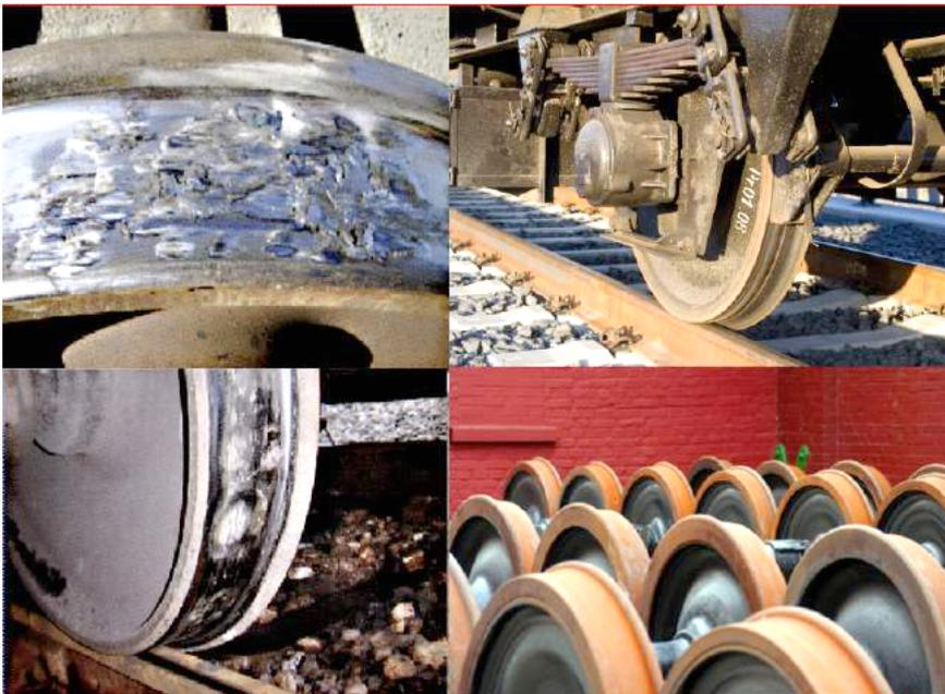
Bild 3: Radfehler wie Flachstellen (links) sind die Folge von schlecht gewarteten Schienen und führen zum typischen „Rattern“, unter dem mehr als 90 Prozent der Anwohner im Rheintal leiden, wie aus der Lärmbefragung von Pro Rheintal hervorgeht.
