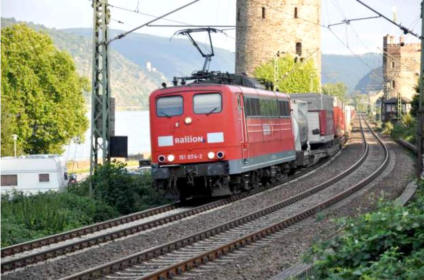
Bild 2: Im Rheintal werden in den zahlreichen engen Kurven durch den sogenannten Stick-Slip-Effekt sowohl die Räder besonders stark abgenutzt als auch die Schienen in Mitleidenschaft gezogen, was den Lärm zusätzlich verstärkt.
