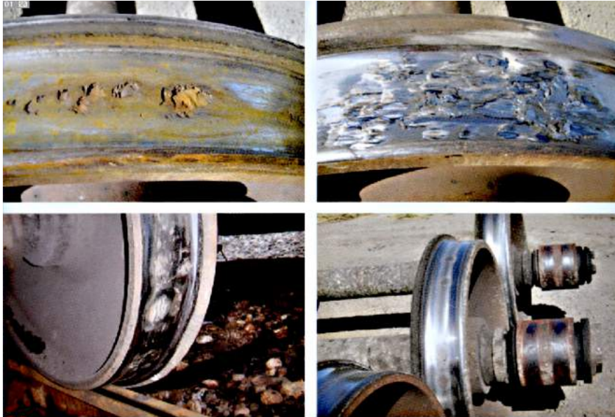
Bild 3: Schadhafte Radreifen sind neben Schienenfehlern die Hauptursache für Bahnlärm und Erschütterungen. Flachstellen (wie rechts oben und links unten zu erkennen) verursachen die besonders lauten und ratternden Bahngeräusche. Hierunter leiden mehr als 90 Prozent der Anwohner im Rheintal, wie aus der Lärmbefragung von Pro Rheintal hervorgeht.
